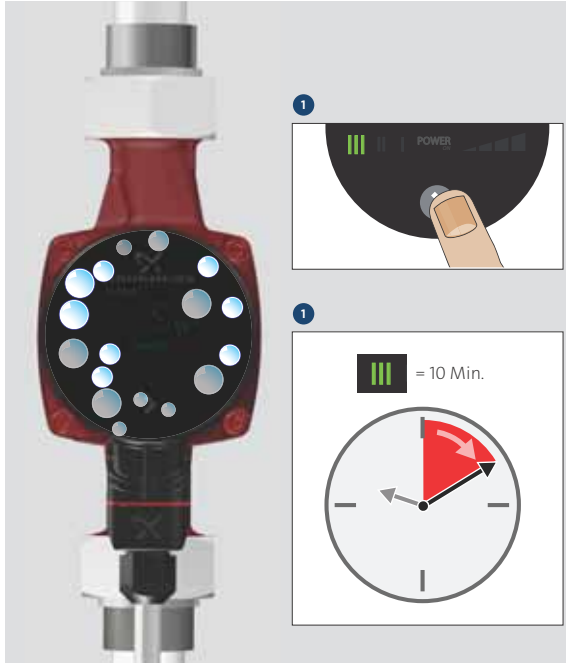
Fig. 12 Purgado de la bomba
