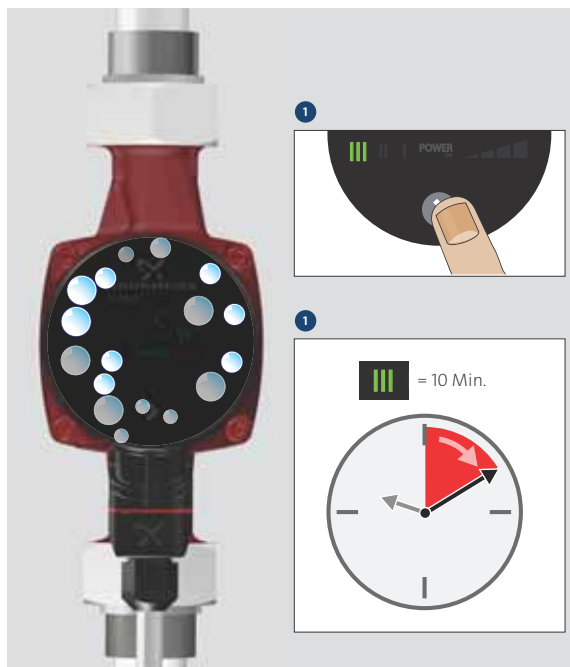
Afb. 12 Ontluchten van de pomp
