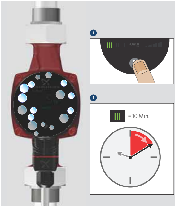
Joonis 12 Pumba õhutamine
